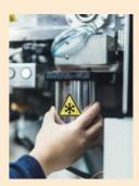
東ったものを真空状態に保たれた電子顕微鏡の内部に入れるのは、手間のかかる作業。横浜キャンパスの電子顕微鏡に搭載された「オートローダー」は、その作業をロボットアームによって自動化。観察の効率化も計られています。
