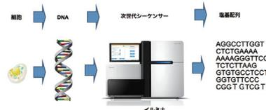
次世代シーケンサーとはDNAの暗号(塩基)の配列を読み取る装置です。この装置により、細胞から採取したDNAは配列へと変換されます。
