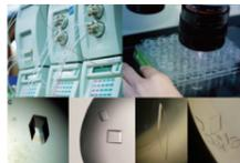
疾患の原因となるタンパク質を精製 (a) および結晶化 (b) している様子。(c) はこうして得られたタンパク質の結晶の写真。このあと、これらの結晶にX線を照射して疾患原因タンパク質の構造を原子分解能で決定し、疾患の治療薬や診断薬を設計 (デザイン) していきます。
